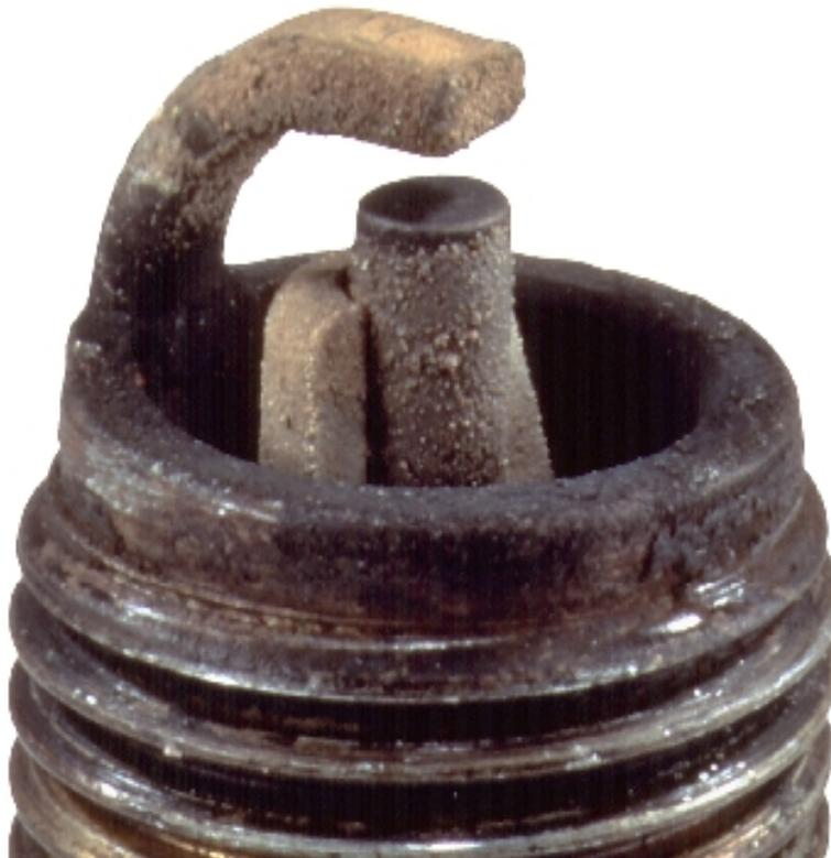
**Keramikbruch durch mechanische Ursache (Montage, Transport, Schlag) oder Thermochock.**
