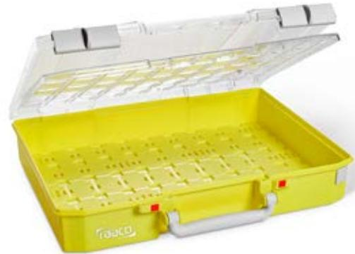
Sortimentskoffer, leer, mit Sandwichdeckel mit U-Profil. Das Einlegefach im Sandwichdeckel nimmt z.B. bis zu 5 lose Dokumentenblätter oder eine Inhaltsübersicht auf. Klickrasterboden im Koffer zur Aufnahme von CA-Einsätzen. 2 RFID-Halter vorne im Koffer, Plombieröffnungen in Deckel und Korpus. Ausgestattet mit Schiebeverschlüssen und Tragegriff. Hergestellt aus PP, Deckel aus PC.
